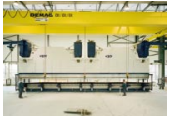
Die große Gesenkbiegepresse in der Produktionshalle der WITEC AG
